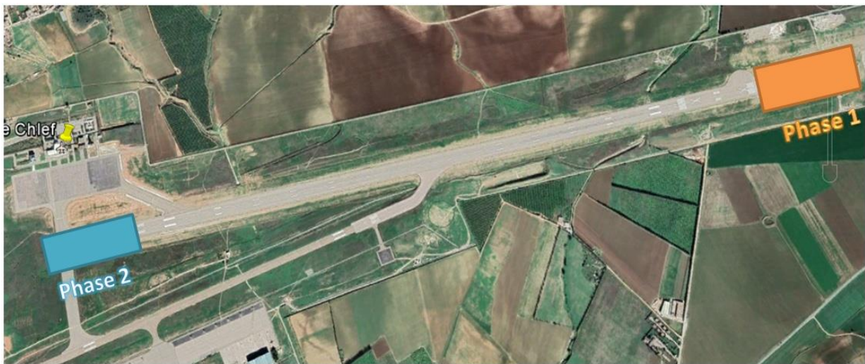
Figure 4.3 : Phasage des travaux
