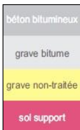
Figure 2 .8 : Les couches d'une chaussée souple.
