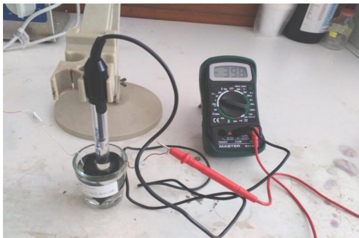
Figure IV.8 : Montage de mesure du potentiel de corrosion
