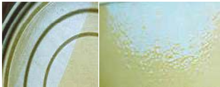
Figure I. 9: Manque de revêtement [2]
