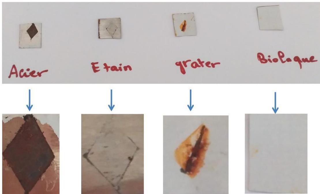
Figure V.8 : Macrographies traduisant l'état de surface du fer blanc après immersion dans la solution simulée SSC
