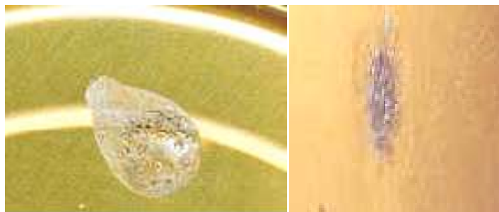
Figure I.10: Coulures de revêtement [2]
