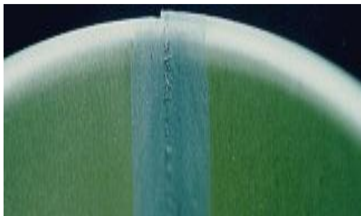
Figure I.14 : Faux équerrage de la boîte [2]
