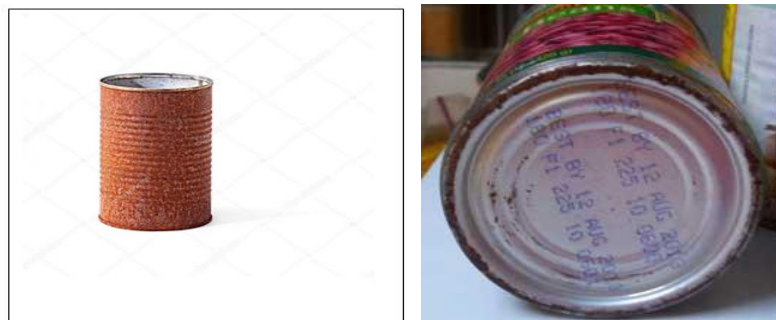
Figure II.20 : Corrosion externe de la boîte de conserve
