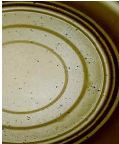
Figure I.11 : Particules étrangères dans le revêtement [2]
