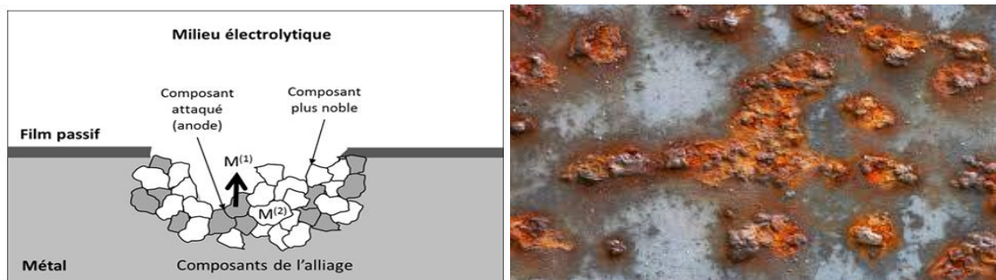
Figure II.9 : La corrosion sélective [9]
