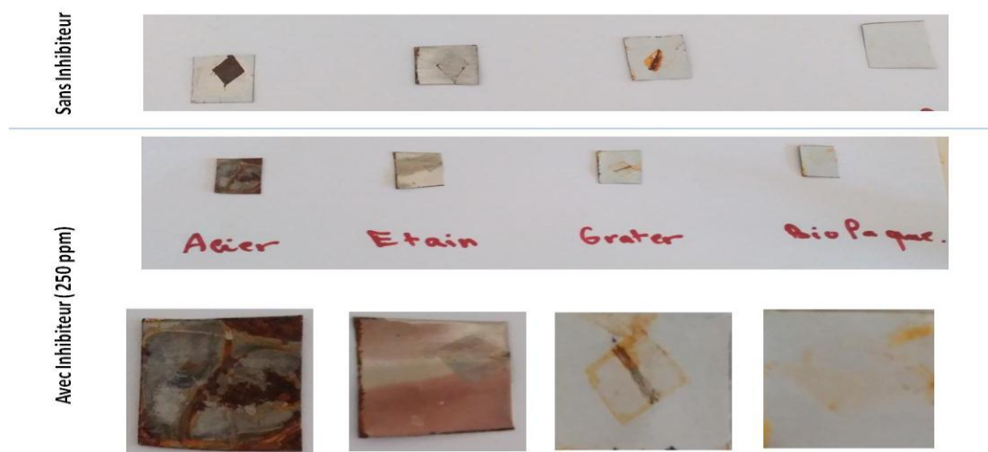
Figure V.16 : Macrographies traduisant l'état de surface du fer blanc après immersion dans la solution simulée SSC en présence de l'inhibiteur
