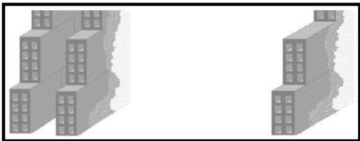
**Figure II.8 :** Double et simple cloisons.
