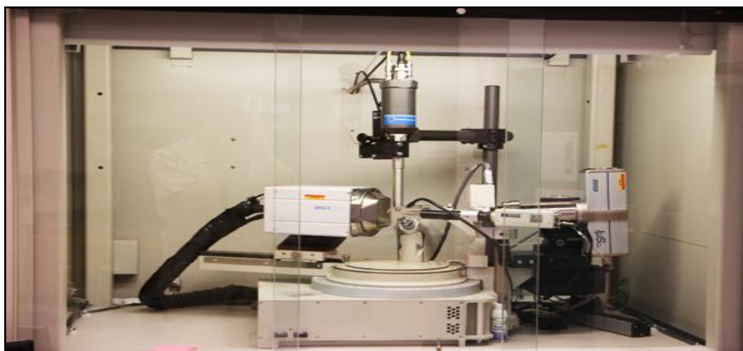
Figure 2.7. Diffractomètre de rayons X Bruker Apex CCD .
