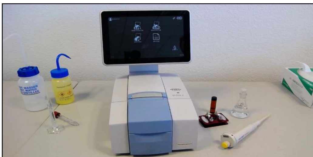
Figure 2.5. Spectromètre infrarouge à transformé de fourier (FT-IR) Bruker Alpha.
