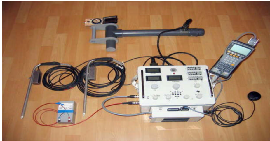
Figure 2.11 : Appareillage géophysique électromagnétique pouvant travailler en mode RMT, RF-EM et VLF-EM GRAD.
