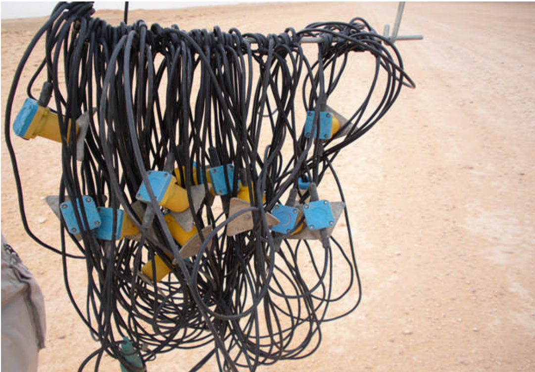
Figure 5.3. Dispositif d'enregistrement : grappe de géophones.
