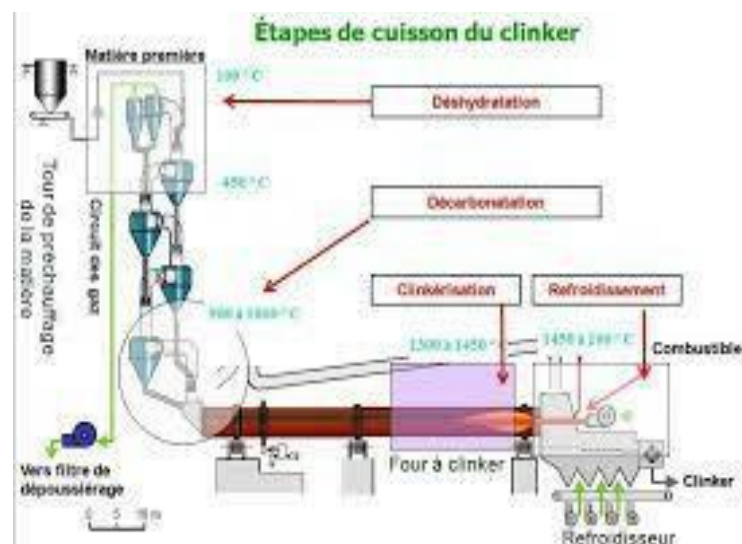
Figure I.24 : Les étapes de cuisson du clinker[7]
