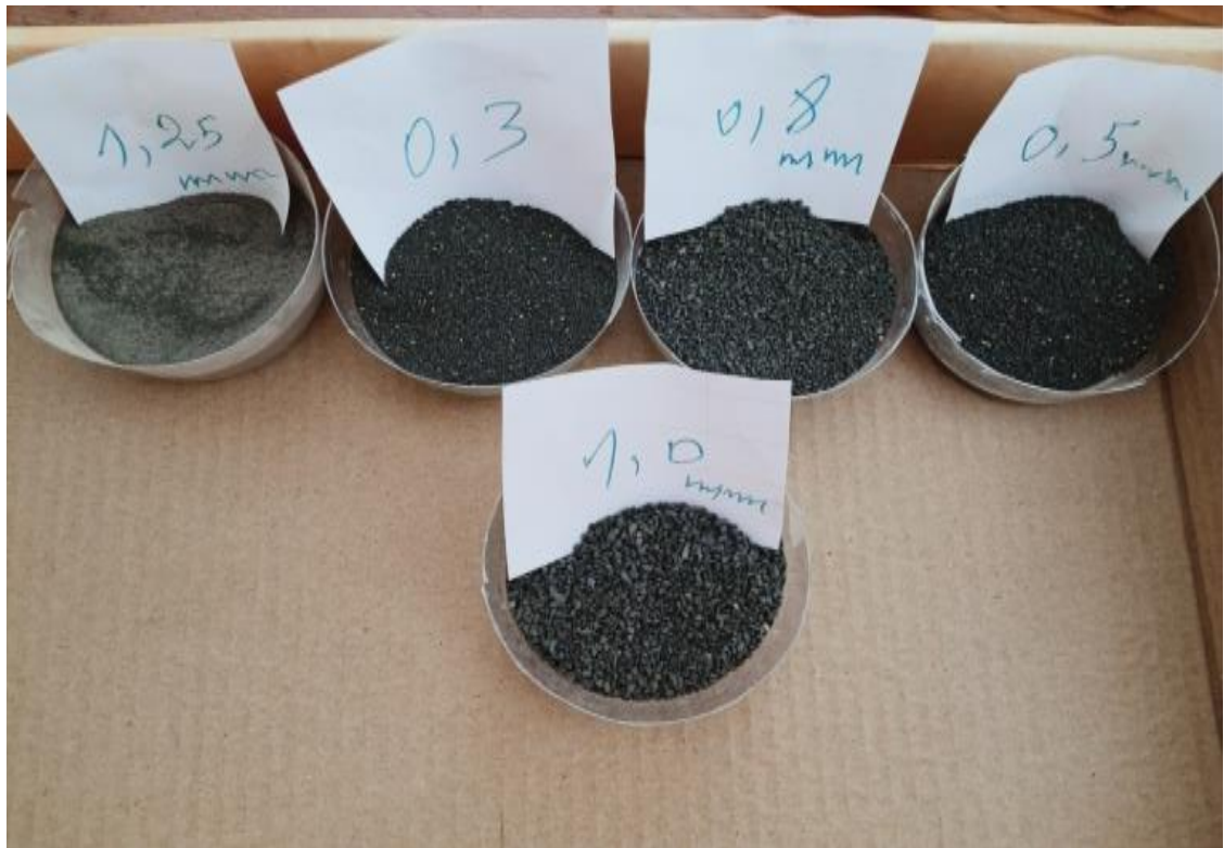
Figure IV.4: Les classes envisagées dans ce travail du clinker obtenu par ajouts du minerai de fer
