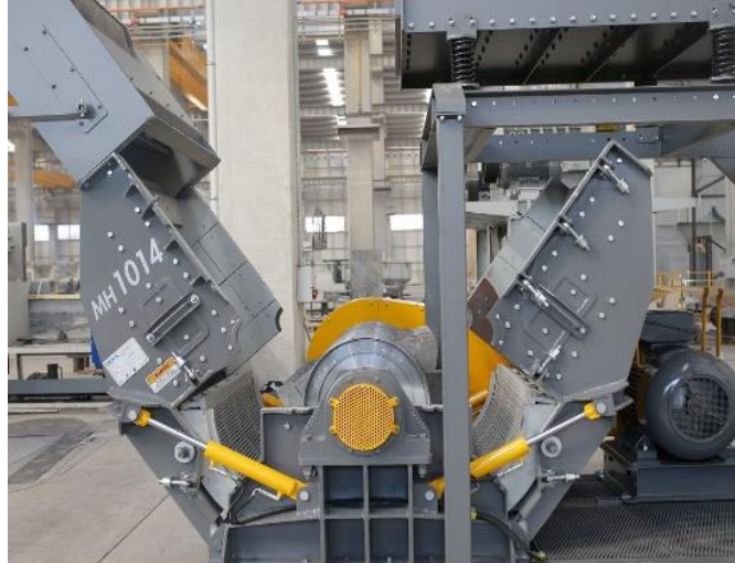
Figure I.3 : Concasseur a marteau du type MEKA où les sections articulées
