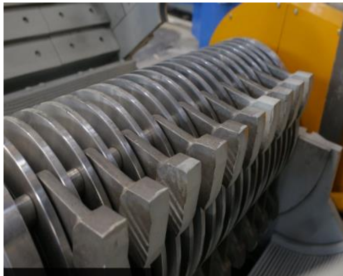
Figure I.4 : Les marteaux du concasseur type MEKA où les marteaux et les grilles qui peuvent être facilement remplacés pour atteindre la taille de grain ciblée
