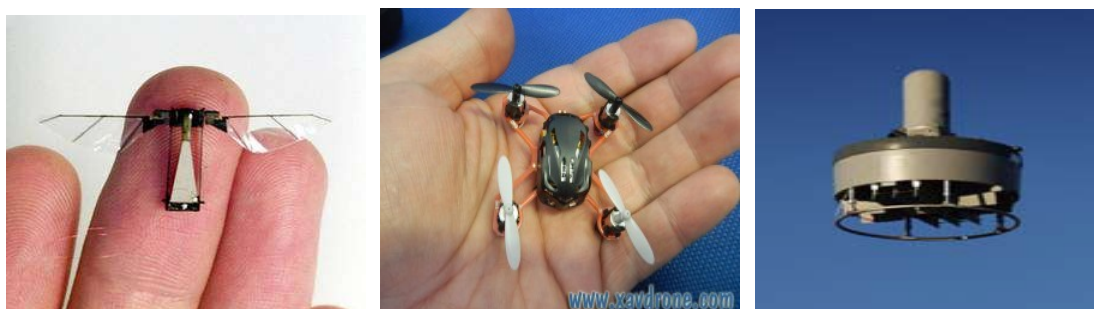
Figure 1.14 : Exemples des micro drones : (a) Drone à aile battante - (b) Drone quadrirotor - (c) Tailsitter à hélice carénée istar
