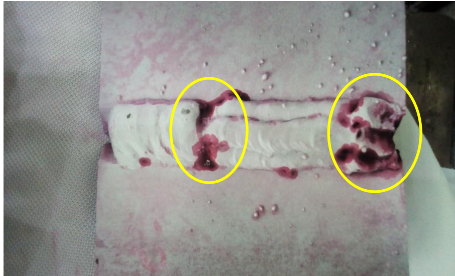
Fig. (IV-9) Piece N°2 et N°3 resultat de Contrôle par ressuage
