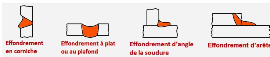
Figure(II.25): différents types d'effondrements.
