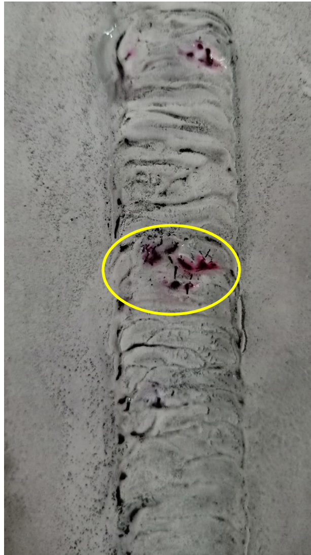
Fig.(IV-12) resultat de Contrôle par magnétoscopie.
