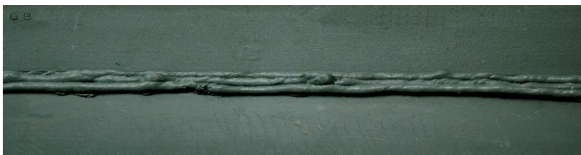
Figure (II.28) : Défaut d'aspect.
