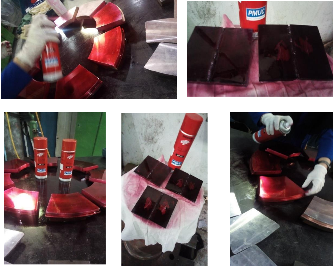
Fig. (IV-7) :Application du pénétrant .
