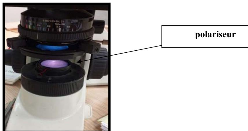
**Photos 02 : Microscope à polarisation (service d'anatomopathologie .HCA.2016).**
