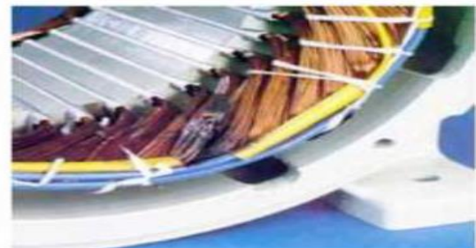
f) Dégradation causée par une surtension
