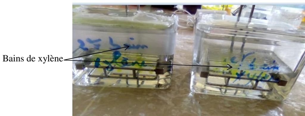
Figure 27 : Photographie de déparaffinage et hydratation en deux bains de xylène (Originale, 2021).
