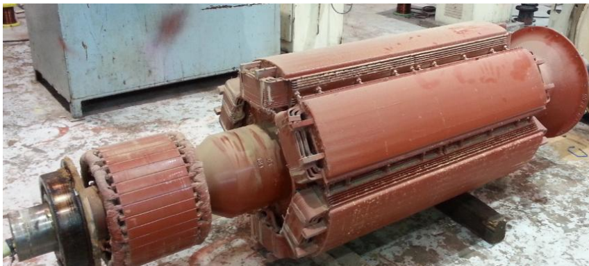
Figure I .4 : Rotor à pole saillant [10]
