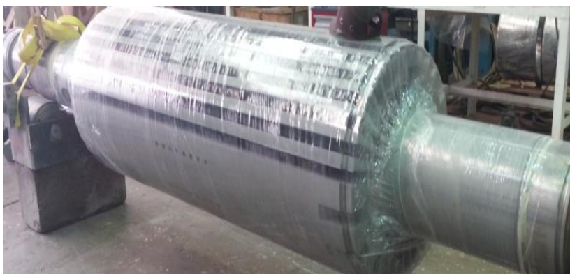
Figure I.5 :Rotor à pole lisse[6]
