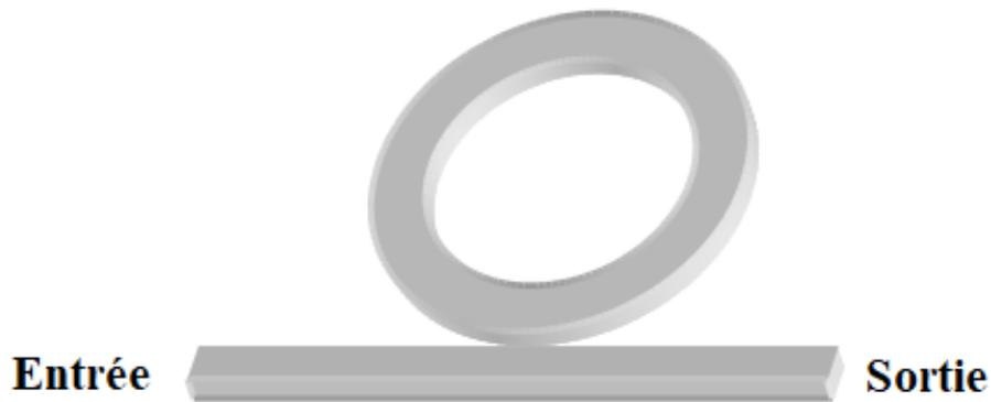
FIGURE 1.17. – Micro-résonateur en anneau à deux ports.
