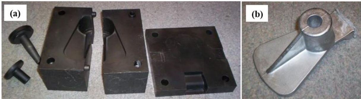
Figure I. 2: (a) Coquille éclatée avec ses broches, (b) pièce obtenue en alliage d'aluminium (Al Si9 Cu3 Mg) [7].
