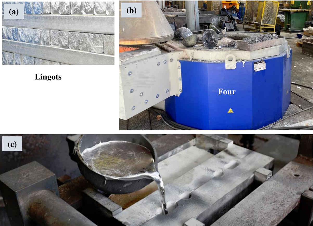
Moulage en coquille par gravité
