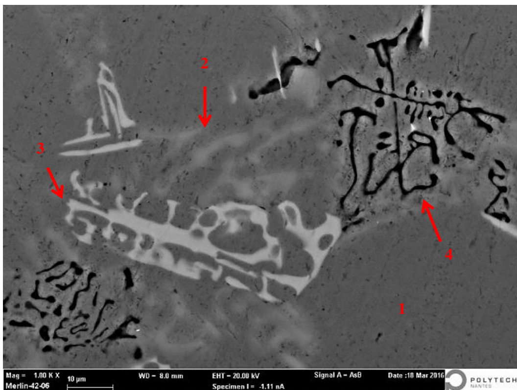
Figure IV. 3 : Images BSE-MEB montrant les principaux intermétalliques et les phases observées dans l'alliage AlSi7Mg : 1) \alpha -Al, 2) Eutectique Si, 3) \pi -Al 8 FeMg 3 Si 6 et 4) M-Mg 2 Si.
