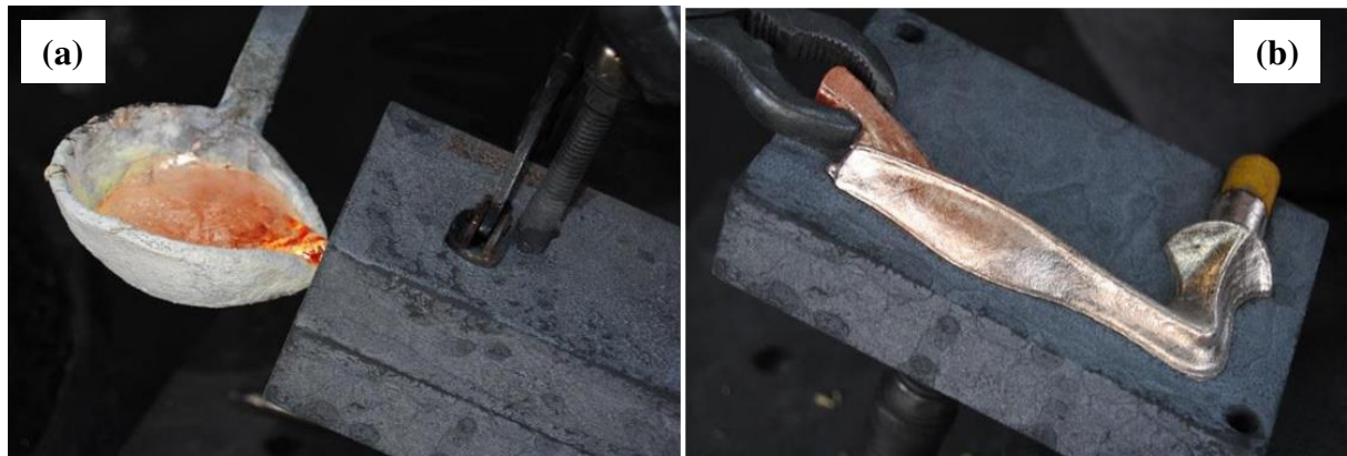
Figure I. 6 : Moulage par gravité en coquille (a) coulée, (b) pièce, images SECODIR sarl.
