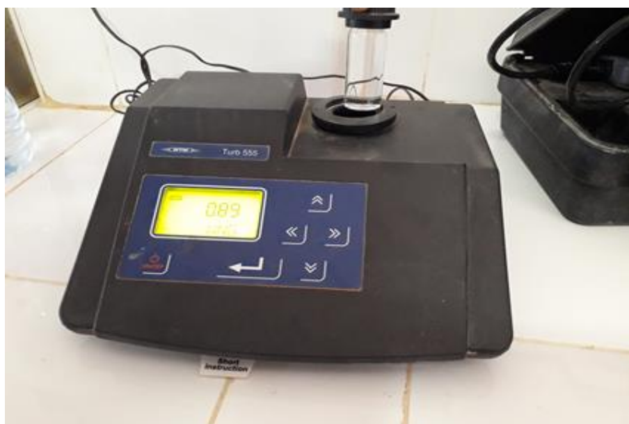
Figure III.4 : Mesure de la turbidité
