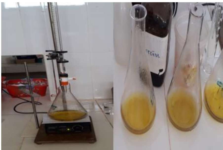
Figure III.13 : Titrage de l'excès de dichromate de potassium
