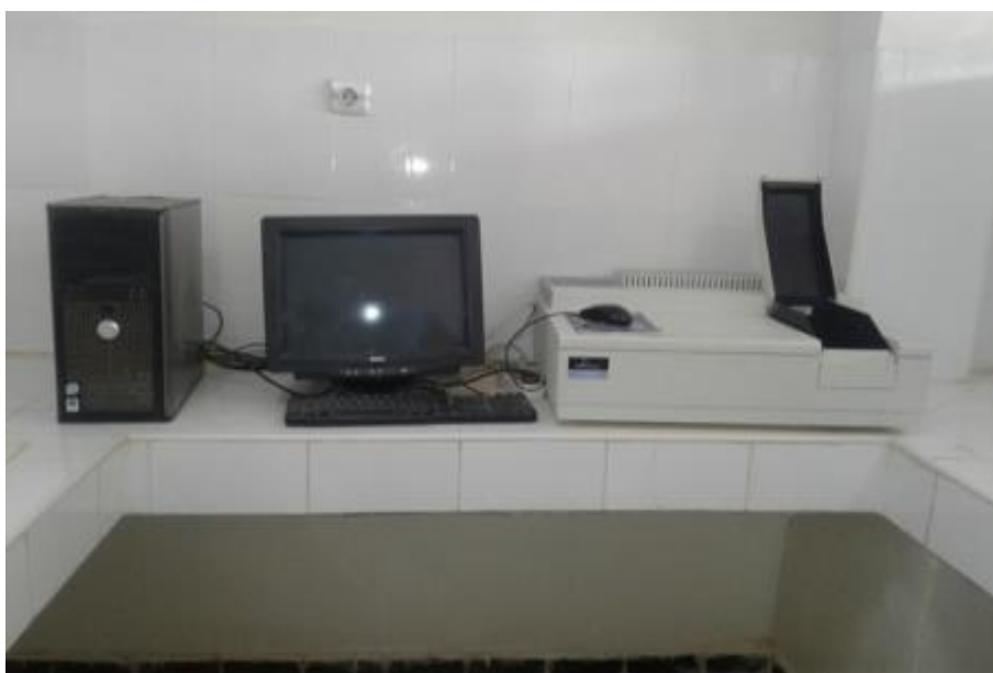
Figure III.10 : UV-Visible pour mesurer la densité optique
