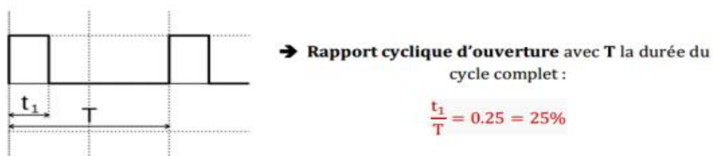
Figure 2.13 : Principe d'un signal de commande par PWM
