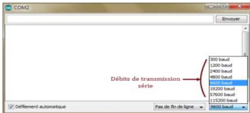
Figure 2.18 : HyperTerminal de l'Arduino (Moniteur Série)
