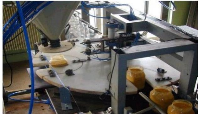
Figure I -7Machine à enrouler le sparadrap sur des rouleaux    Figure I -8 Machine à remplir des pots de peinture
