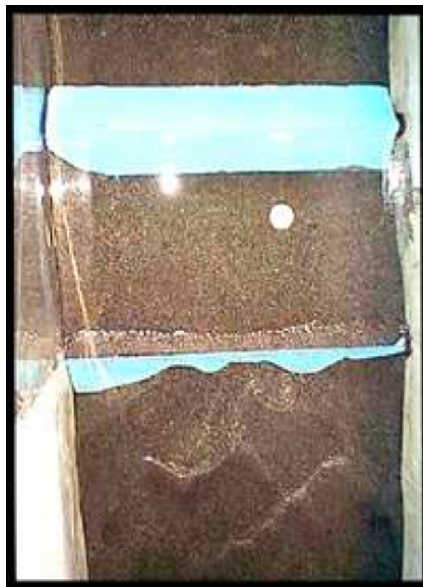
Figure (14a). Sur modèle réduit. L'efficacité de l'implantation de deux Drâas placées parallèlement à la chaussée, une quantité de sable est piégée par le Drâas.
