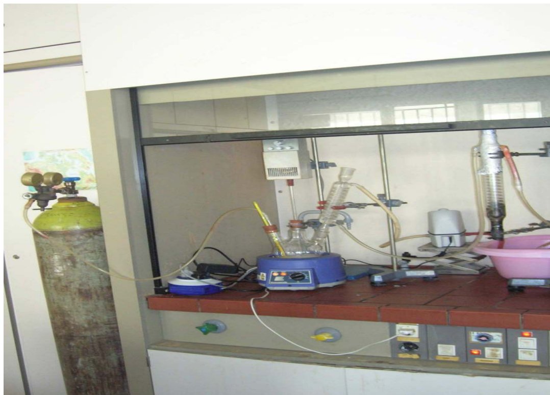
Figure. 5 : Montage utilisé pour la synthèse de PP-g-MA
