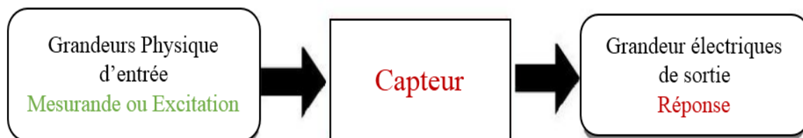
Figure I-2 : Schéma explicatif du rôle d'un capteur
