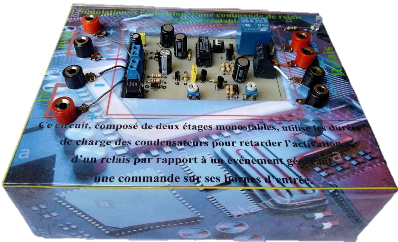
Figure III-28 : Image de la carte électronique d'une commande de relais à retard réglable
